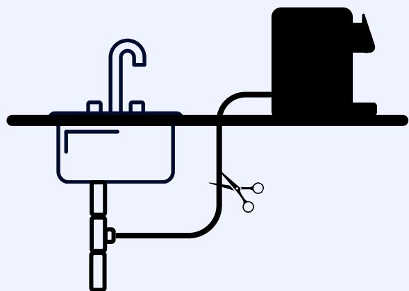
Connectez le préfiltre de part et d'autre, en veillant à respecter le sens des flèches
